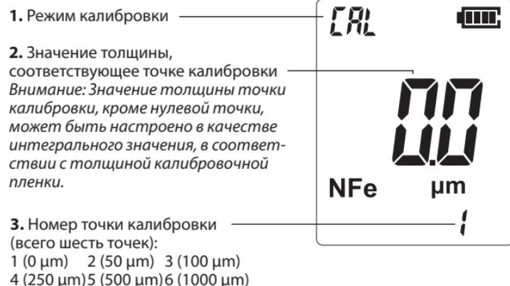
**В.** На данный момент в нижнем правом углу экрана отображается «1», а стандартное значение толщины в центре дисплея – «0,0». Это означает, что нулевая точка уже откалибрована. Совершив однократное измерение подложки из магнитного или немагнитного материала, прибор подаст два звуковых сигнала. После этого калибровка нулевой точки закончена и прибор автоматически переходит к следующей точке калибровки.
